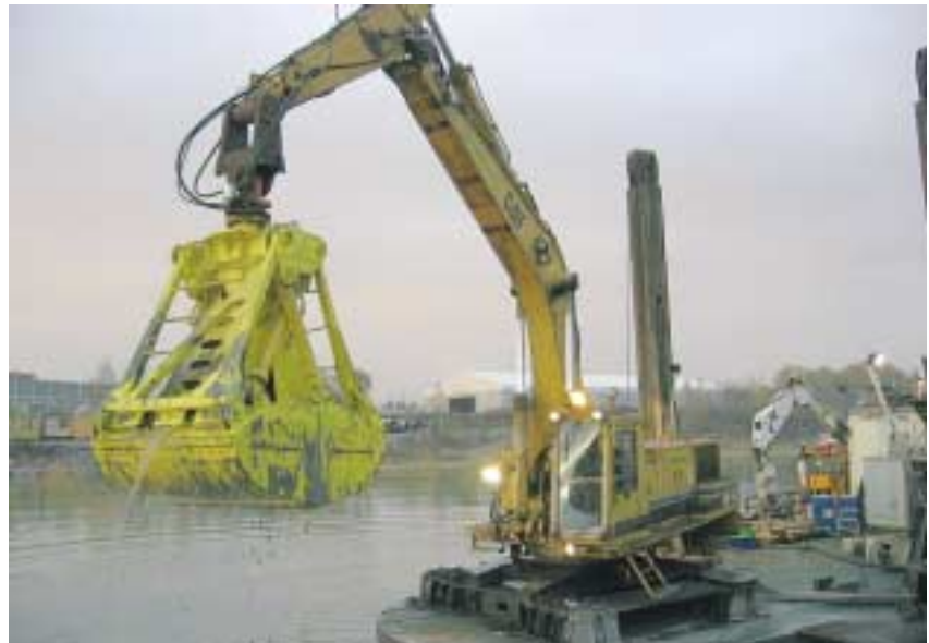
Sedimenttiruoppauskauha kiinnitettynä Marika ruoppaajaan
